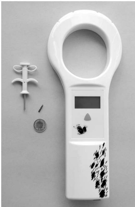
Abb. 4.1.1 Lesegerät (rechts), Mikrochip (mitte) und Implantationsnadel (links) wie sie für die Registrierung von Hunden verwendet werden.
